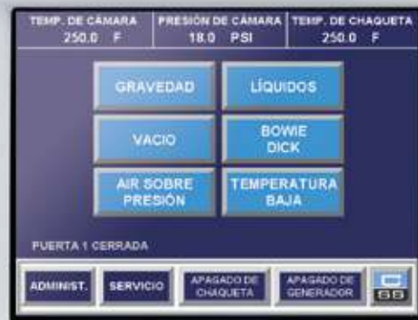
El Controlador ADV-PRO™ está configurado para los productos Consolidated. Utiliza la PLC Allen Bradley® probada, el cual es un controlador de fuente abierta con respaldo mundial.
